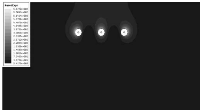
Fig. 16. Distribución de la densidad de pérdidas en W/m 2 en la placa con barrenos de 4.6cm de diámetro
