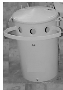
Fig. 1. Barrenos en el tanque de un transformador de distribución monofásico.
